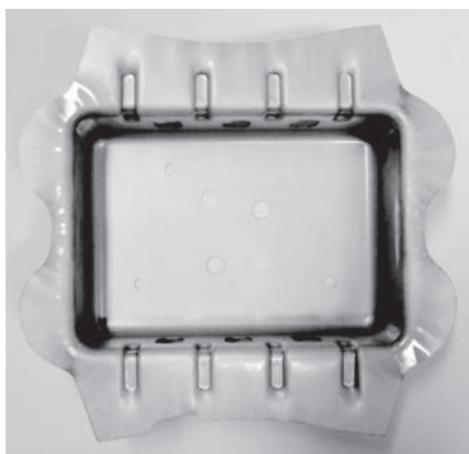
図3 材料削減例 実機絞り工程
